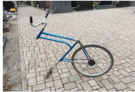
Entièrement fabriqué par nos agents du service technique à partir d'un vélo récupéré sur lequel a été fixé une petite plaque avec des bords tranchants, ce curieux engin permettra de retirer plus efficacement et rapidement les mauvaises herbes et plantes indésirables dans les allées du cimetière.
